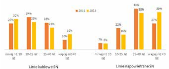
Rys. 5. Porównanie wieku linii napowietrznych i kablowych SN dla lat 2011 i 2018 (opracowanie własne na podstawie danych OSD)
