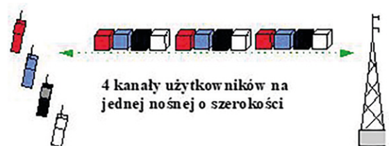
Rys. 3. Struktura ramki TDMA. Pasma kanału radiowego 25 kHz
